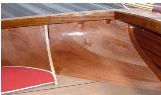
Foto 10: Risultato finale dell'applicazione delle singole dime di legno sul Feather 14', un cat boat progettato e realizzato dal Cantiere impiegando la stessa tecnologia costruttiva, che ha consentito di realizzare una barca di 14', abilitata per 4 persone, del peso di soli 125 kg completamente armata.
